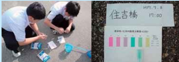
▲バックテストによる水質調査中です。 ▲バックテストによる水質調査の結果です。
