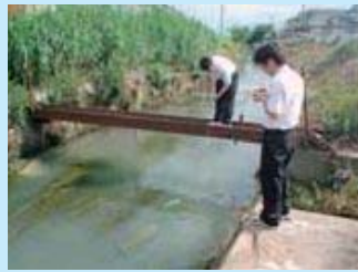
▲川の水流の流速を測定しています。
